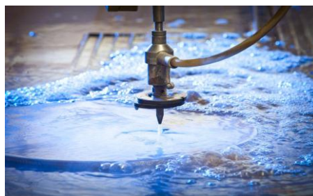
شکل ۳: برش قطعه با واتر جت و آماده سازی نمونه
