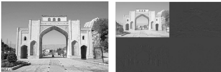
شکل (۱): چهار زیر باند تجزیه شده تصویر دروازه قرآن شیراز با استفاده از DWT
