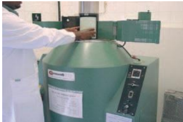
شکل ۶: سیستم پرتودهی درون کار گاماسل - ۲۲۰ در حال بهره‌برداری در پژوهشکده کاربرد پرتوها در سازمان انرژی اتمی ایران
