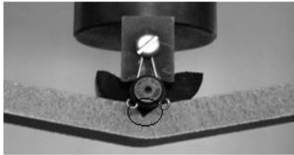
شکل ۷ شروع خرابی نمونه خمش از رویه بالایی
