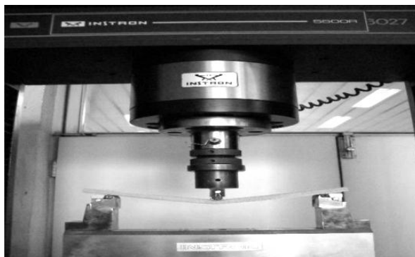
شکل ۳ آزمون خمش سه نقطه‌ای طبق استاندارد ASTM-C393
