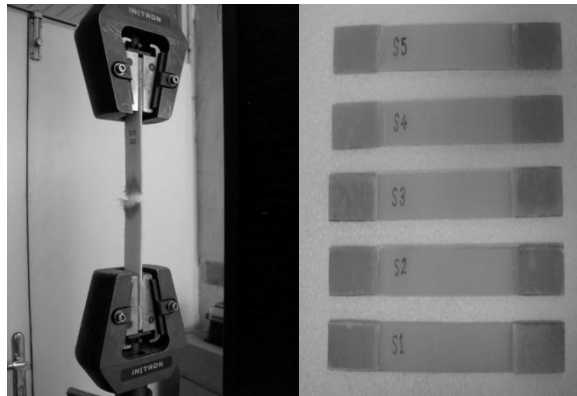
شکل ۴-الف) آزمون کشش نمونه شماره ۳ شکل ۴-ب) نمونه‌های کشش
