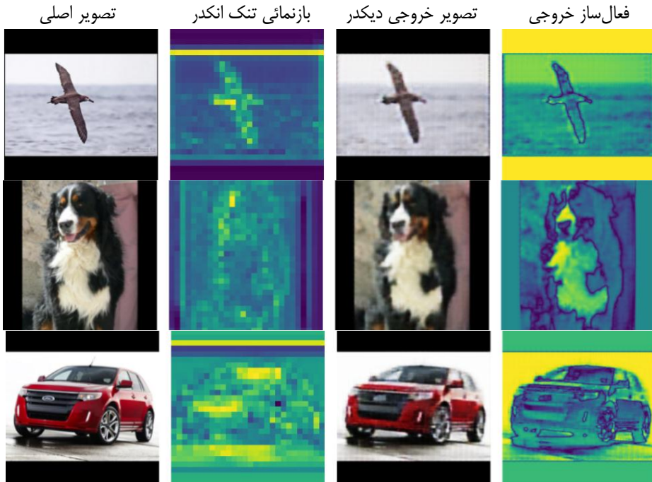
شکل ۵: بازنمایی تصاویر تنک در مدل SAE. به ترتیب از چپ به راست: تصاویر طبیعی، فعال‌ساز ویژگی - های تنک در خروجی انکدر، تصویر بازسازی شده در دیکدر و فعال‌ساز خروجی دیکدر
