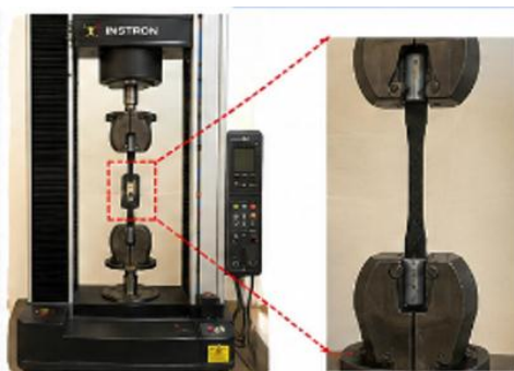
شکل ۴: قرارگیری نمونه در دستگاه کشش اینسترون
