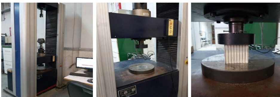
شکل ۱۲: دستگاه آزمون فشار WDW-300E و نحوه قرارگیری نمونه در دستگاه
