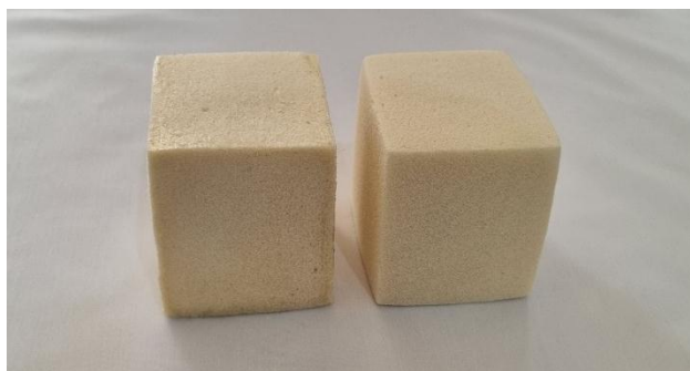
شکل ۹: نمونه‌های ساخته شده مکعبی از فوم پلی اورتان
