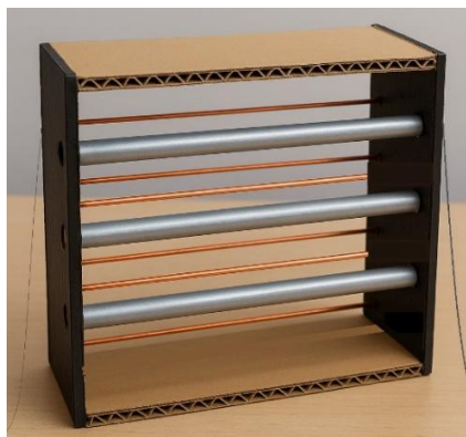
شکل ۸: پيشرانش پلاسمایی (ساخته شده با پرینتر سه بعدی)
