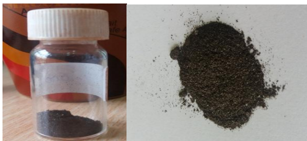
شکل ۲- تهیه نانوذرات فریت کبالت / منیزیم به روش سل-ژل
