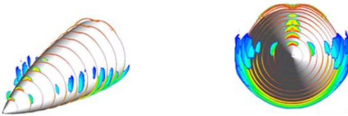
شکل ۱۶: ساختارهای گردابه‌ای اطراف نوک موشک در ماخ 3/7 و زاویه حمله 15 درجه در سطح دریا
